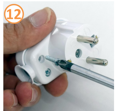
Викрутіть центральний гвинт та один з гвинтів фіксатора повністю, а другий - на половину.
