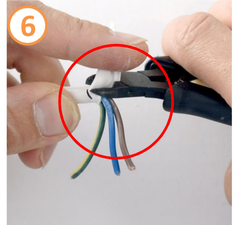
Відріжте зовнішню ізоляцію до мітки.
